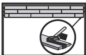
Pour placer le panneau dans la bonne position, placez le pied-de-biche Quick-Step® sur le bord de la lame et emboîtez la lame à l'aide d'un marteau.
