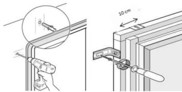
Une fois le cadre posé ,vérifier l' aplomb et les diagonales. Rectifier si nécessaire .Fixer définitivement et remettre les vantaux en place . Un réglage peut parfois être nécessaire pour rectifier 1 ou 2 mm (tolérance acceptable de pose)
