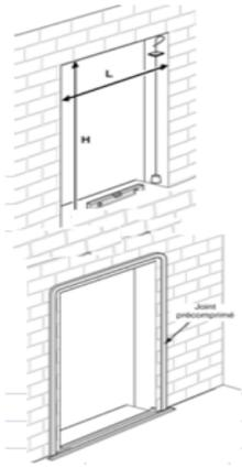
Poser le joint pré comprimé sur le pourtour de la maçonnerie ou sur extérieur dormant de la fenêtre pour une pose en tunnel
