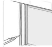
Si votre vantail ne se plaque pas bien sur le dormant vous devez régler la crémonne .Utilisez une clef BTR de 4 mm .Avancer ou reculer les rouleaux excentriques de la crémonne .
