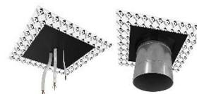
Réaliser une ouverture dans la membrane *Hygro'Vap* pour faire passer l'élément traversant. Retirer la partie pré-découpée du manchon selon le diamètre de la pénétration à étancher. Faire passer le manchon à travers l'élément traversant et coller le sur la membrane *Hygro'Vap* en retirant le papier pelable.
