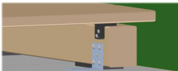
Figure 8 : fixez le clip de fin à l'ossature en le vissant.
